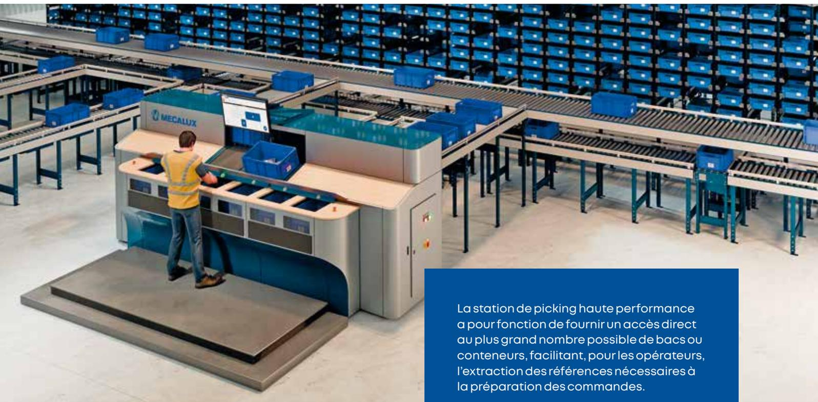
La station de picking haute performance a pour fonction de fournir un accès direct au plus grand nombre possible de bacs ou conteneurs, facilitant, pour les opérateurs, l'extraction des références nécessaires à la préparation des commandes.
