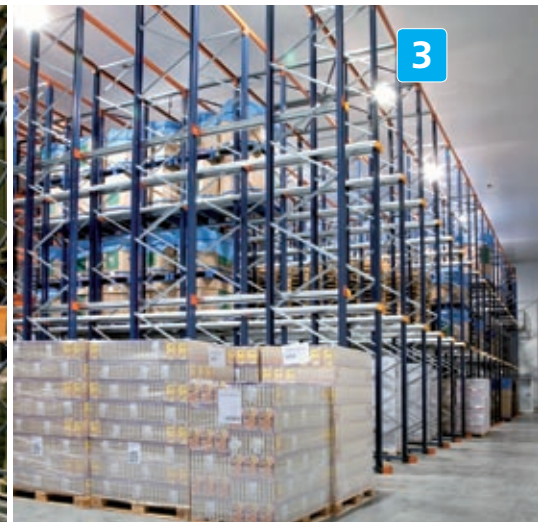
Les rayonnages par accumulation permettent de stocker des produits à référence unique et à longue durée de stockage.
