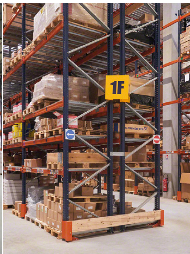
Protection latérale avec un profil
