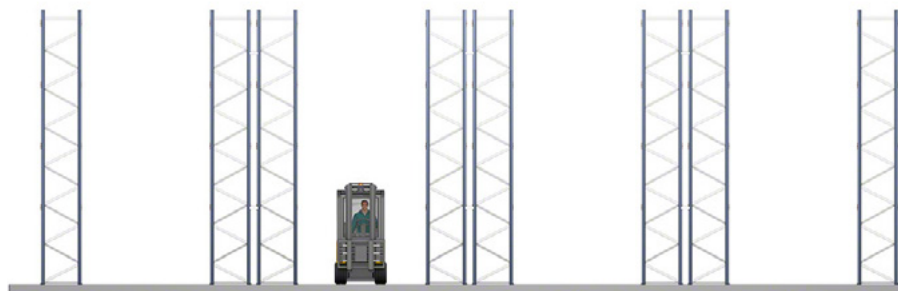
Palettier composé d'un rayonnage simple adossé au mur et de rayonnages doubles
