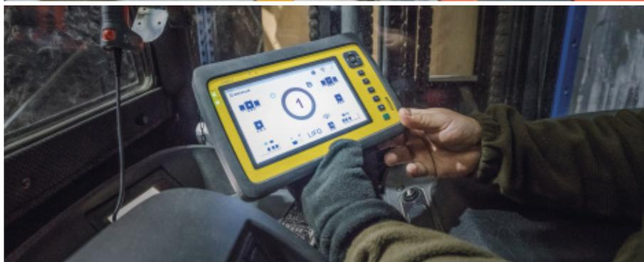
L'opérateur du chariot élévateur communique à la navette les indications de stockage et d'extraction par l'intermédiaire d'une tablette dotée d'une connexion wi-fi permettant de travailler à basse température.
