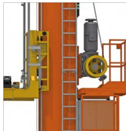
Échelle et plate-forme de maintenance supérieure.
